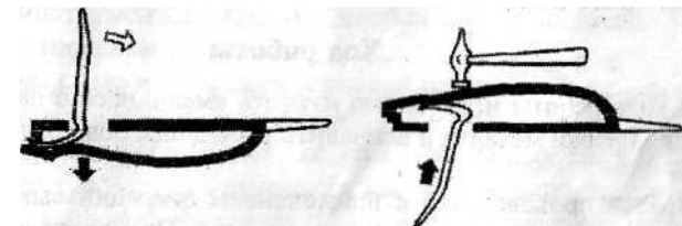
Рис. 7.2. Выколотка труднодоступных полостей
