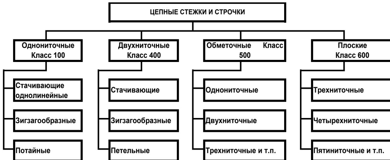
Рис. 2.5. Классификация цепных стежков и строчек
