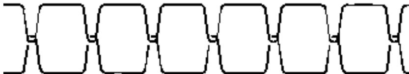
Рис. 2.1. Строение двухниточной стачивающей строчки челночного стежка
