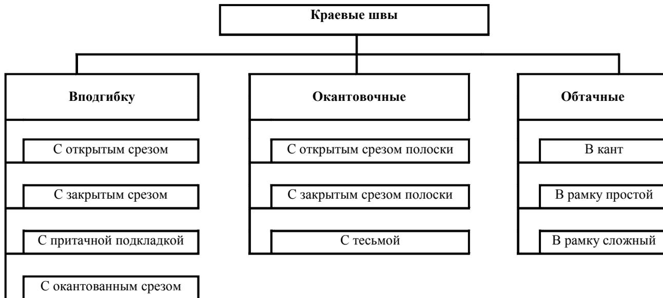
Рис. 3.2. Классификация краевых швов
