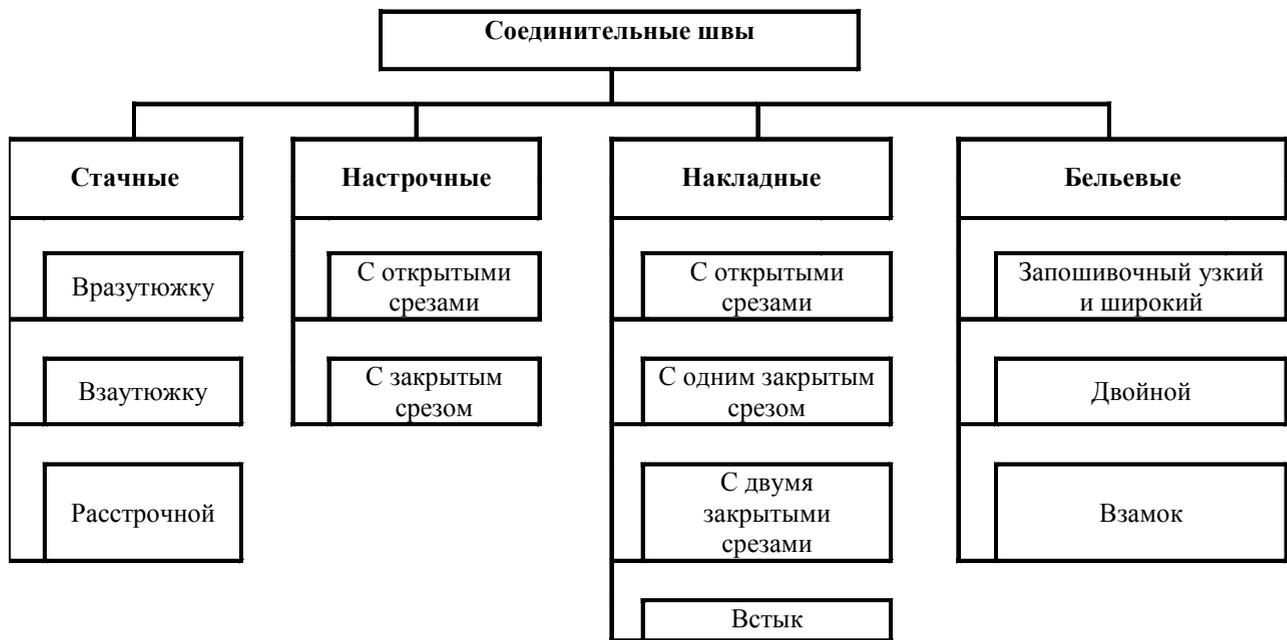
Рис. 3.1. Классификация соединительных швов
