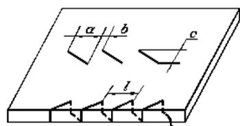
Рис. 1.3. Строение косых стежков
