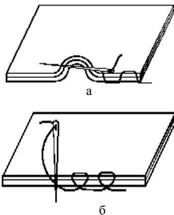
Рис. 1.1. Способы образования ручных стежков
