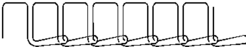
Рис. 2.3. Строение стачивающей однолинейной однониточной строчки цепного стежка
