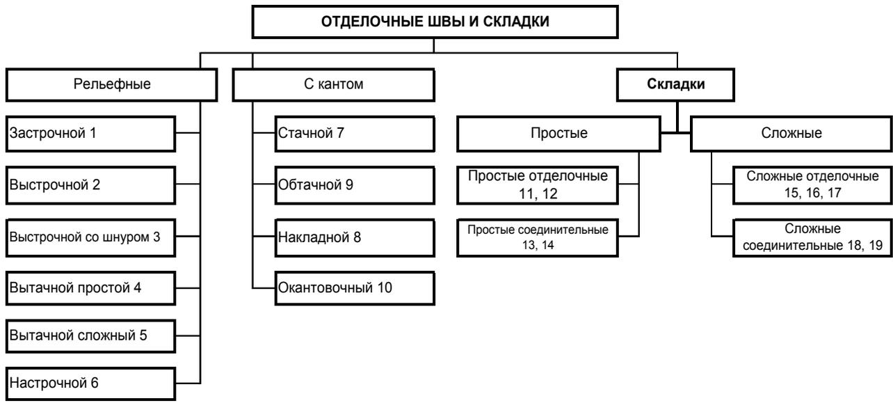
Рис. 5.2. Схема видов отделочных швов и складок
