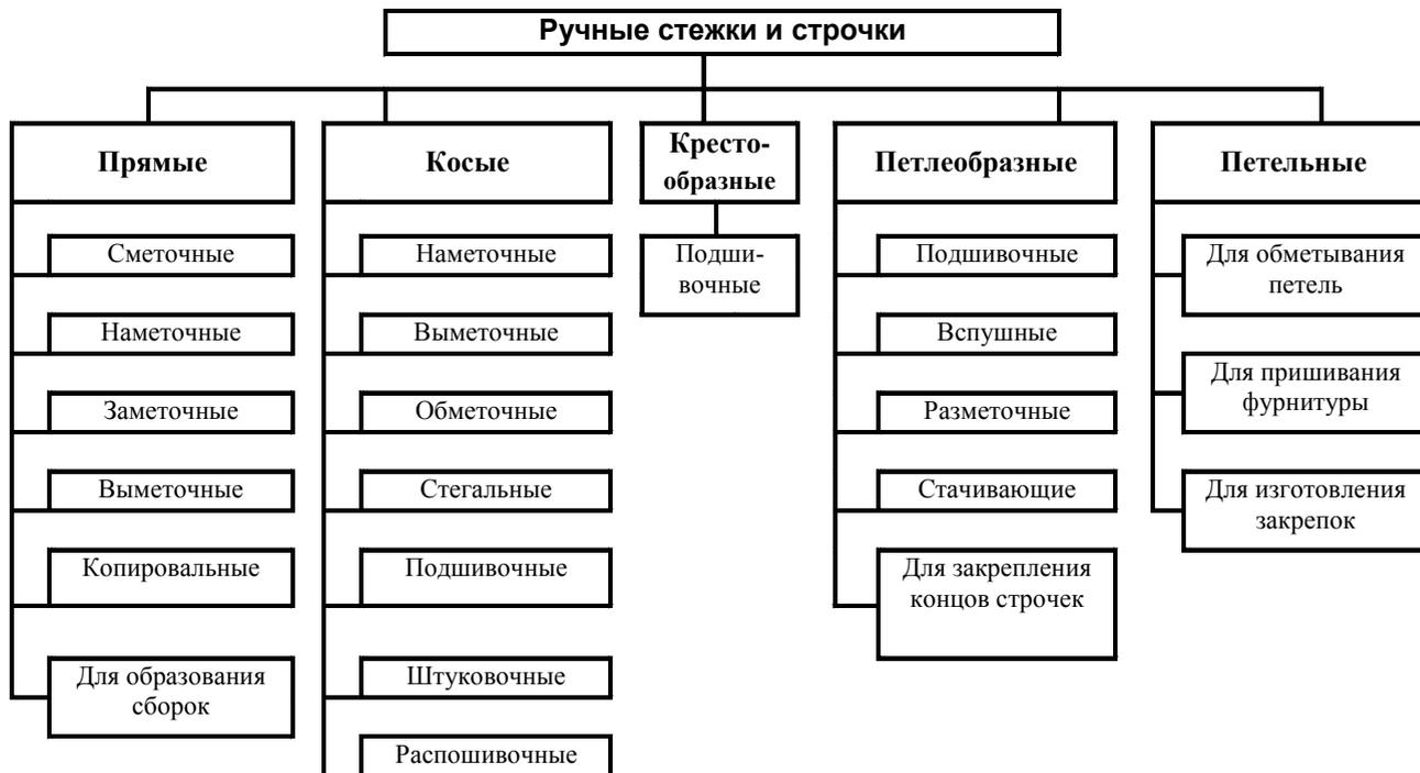
Рис. 1.4. Классификация ручных стежков и строчек
