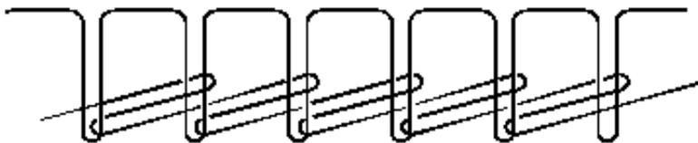
Рис. 2.4. Строение стачивающей однолинейной двухниточной строчки цепного стежка
