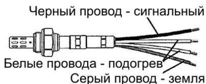
Рис. 2.4. Четырехпроводный кислородный датчик
