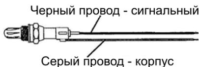
Рис. 2.2. Двухпроводный кислородный датчик
