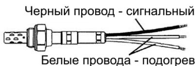
Рис. 2.3. Трехпроводный кислородный датчик
