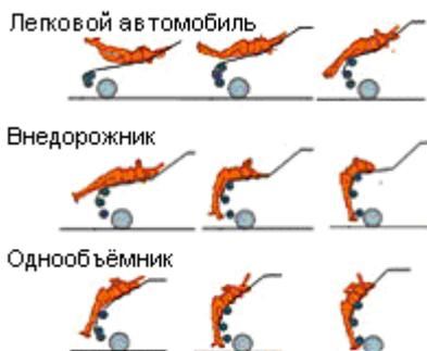
Рис. 3.5. Результаты компьютерного моделирования контакта пешехода с передком автомобилей разных типов [8]
