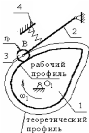
Рис. 8.1. Высшая кинематическая пара: 1 – кулачок; 2 – толкатель; 3 – ролик; 4 – пружина
