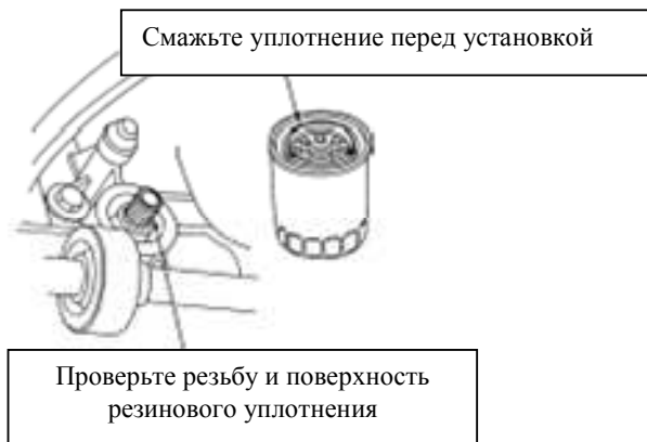
Рис. 2.13. Подготовка поверхности перед установкой
