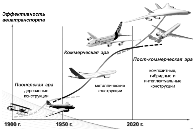
Рис. 1.6. Основные этапы развития компоновочных и конструктивно-силовых схем гражданских самолетов
