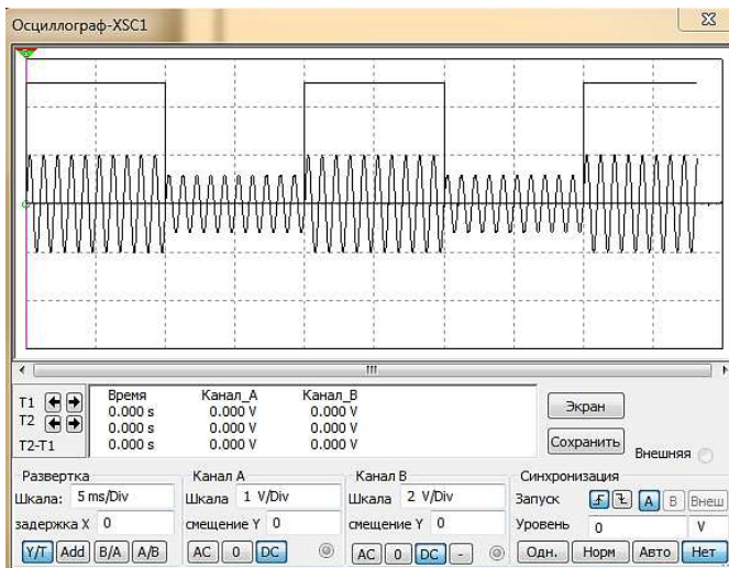
Рис. 3.15. Окно осциллографа. Вид амплитудной манипуляции и сигнала сообщения
