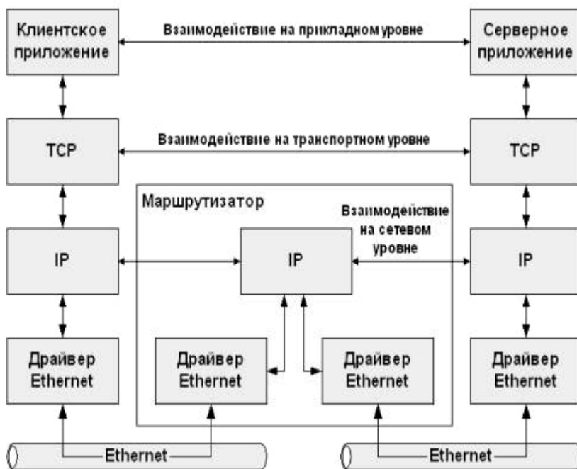
Рисунок 8.3. Взаимодействие двух компьютеров с использованием стека протоколов TCP/IP
