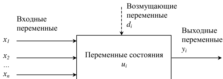
Рис. 2.4. Характеристики системы с помощью входных, выходных и возмущающих переменных, а также переменных состояния
