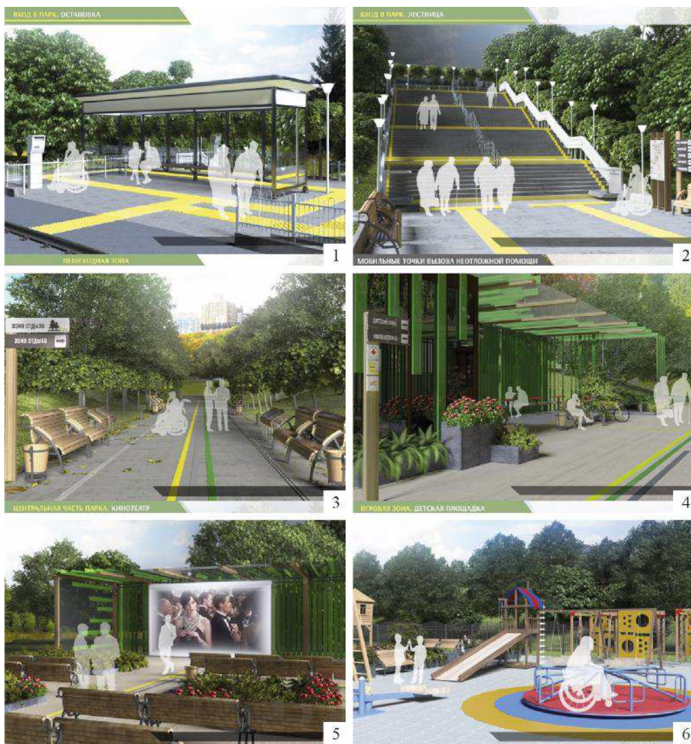
Рис. 3.21. Ландшафтная организация северо-западной части парка «Минный городок» с адаптацией для МГН. Видовые кадры: 1 – оборудование остановки общественного транспорта у центрального входа в парк; 2 – оборудование подъемником лестницы центрального входа; 3 – организация сигнальной разметки на прогулочных дорожках; 4 – оборудование зон отдыха с кнопками вызова экстренной помощи; 5 – кинотеатр под открытым небом на центральной площади парка; 6 – детская зона с игровым оборудованием для МГН
