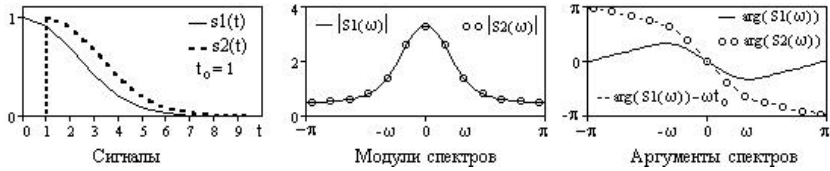
Рис. 3.8. Изменение спектра сигнала при его сдвиге.
