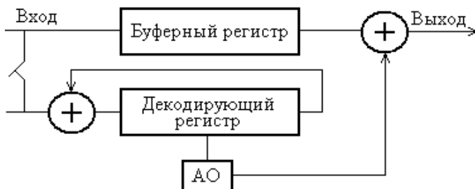
Рис. 16.4. Схема декодирования циклического кода. АО – анализатор ошибок
