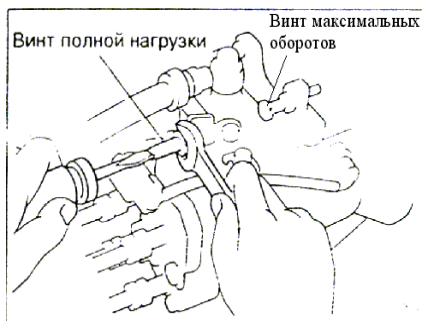
Рис. 10.10. Регулировка объема впрыска топлива
