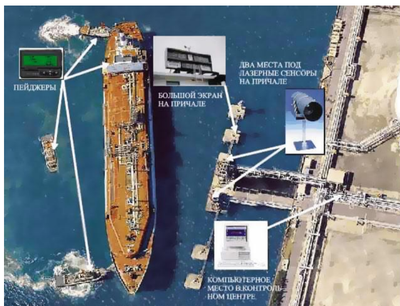
Рисунок 4. Схема работы лазерной системы швартовки крупнотоннажных судов, установленной на нефтеналивном терминале Шесхарис в Новороссийске. Лазерные датчики, установленные на причале, измеряют дальность до судна и скорость сближения по корме и носу. Система предназначена для повышения безопасности в процессе причаливания и швартовки судов, а также мониторинга их состояния после постановки к причалу. Схема с сайта www.transas.ru
