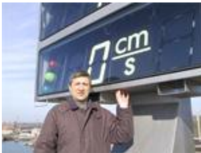
Рисунок 5. Табло лазерной системы швартовки, установленное на нефтеналивном терминале Шесхарис в Новороссийске. Фото с сайта www.eltrans.ru
