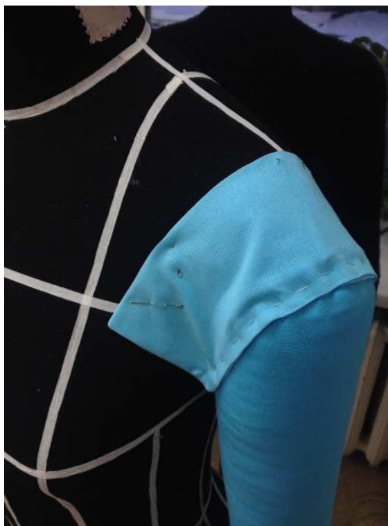
Рис. 2.35. Пришивание полоски к верхней части оката рукава для прикрепления руки к манекену
