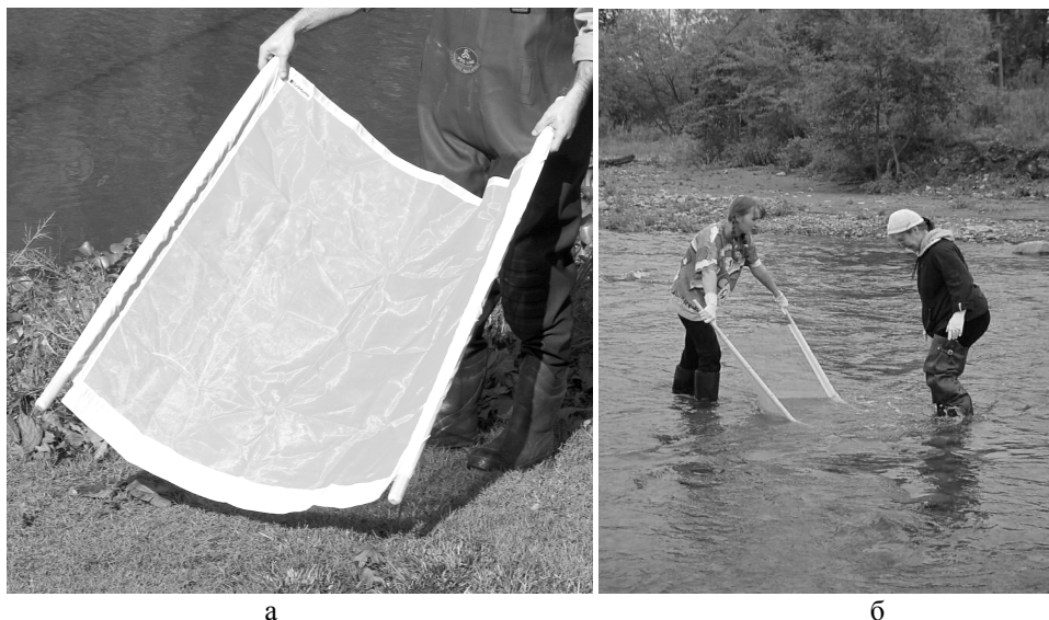
Рис. 4.5. Отбор проб методом принудительного дрефта с помощью ручного экрана: а – ручной экран; б – процедура отбора проб на водотоке
