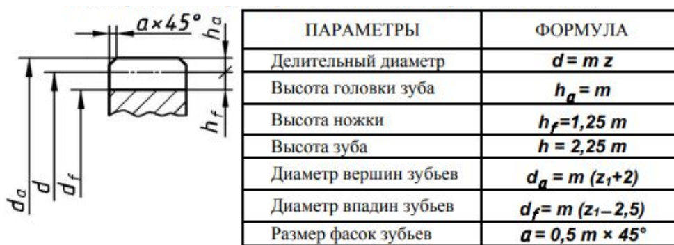
Рисунок 5.2.11 – Геометрические параметры зубчатых цилиндрических колес
