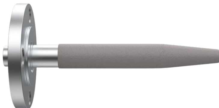
Рис. 3. Цельноточенная фланцевая защитная гильза модели ГЗ-ФЦ со стеллитовым покрытием
