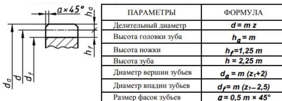
Рисунок 5.2.11 – Геометрические параметры зубчатых цилиндрических колес
